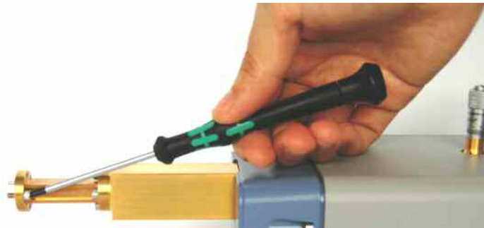
Abb. 4.5: Verschrauben eines Messtores
