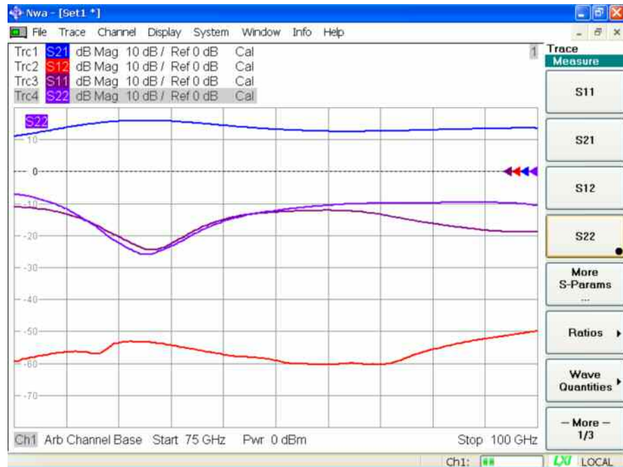
Abb. 4.17: Messergebnis zu Verstärker IAF MDMAW01BM
