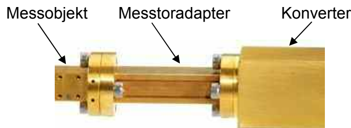
Abb. 2.2: Empfohlener Aufbau für den Anschluss des Messobjektes
