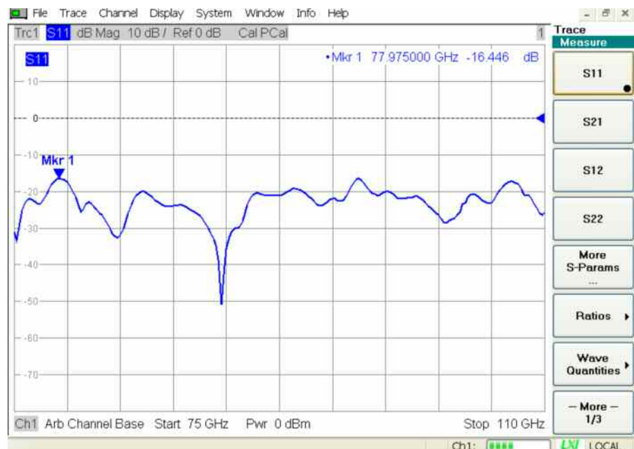
Abb. 4.12: Messung der Rückflussdämpfung am RF-Tor eines Mischer FS-Z110
